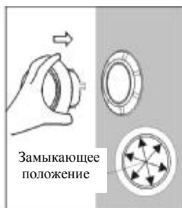
Установка диффузора в корпусе. Одна из насечек на диффузоре должна быть направлена в середину места фиксации
